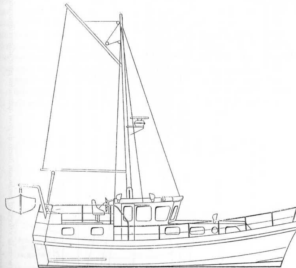
Fig. 39. Crucero de motor de velocidad media con las líneas de popa planas para proporcionar mayor sustentación en la popa.
