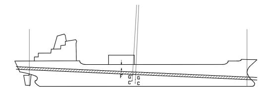
En la medida que no carguemos en esta vertical, se producirá una alteración. Para evaluar la alteración, en primer lugar consideramos que hemos cargado o descargado de la vertical de F y después trasladamos el peso la distancia hasta el punto de carga o descarga. El signo del peso será + para la carga y – para la descarga. La carga o descarga en la vertical de F produce una inmersión o emersión que se puede evaluar por la fórmula:
