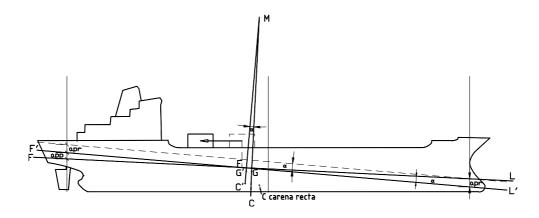
En el dibujo tenemos dos triángulos semejantes, uno es el formado por los vértices G', G y M y el otro es el formado por los lados siguientes: la línea punteada, la flotación F-L y por la alteración medida sobre la perpendicular de popa. Así podemos poner:
