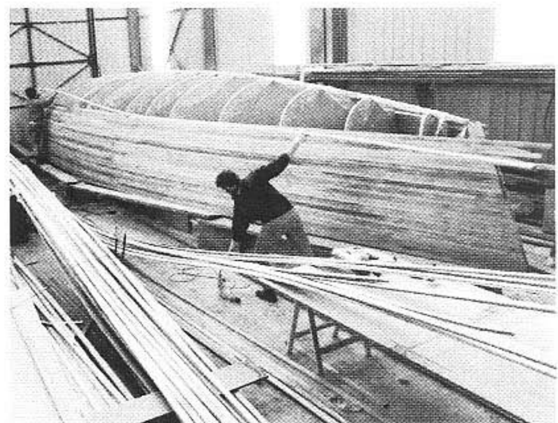
Stripping up a wood-epoxy strip-plank hull. (Courtesy Alan Salisch)
